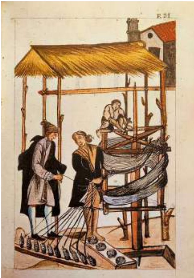
Figura | Figure: 1 Baltazar Martínez Compañón, Yndios urdiendo lana , acuarela. Se puede apreciar una urdidera, máquina que servía para tender los hilos de la urdimbre. Códice Trujillo del Perú (1782-1785), Tomo 2, fol. 91.
